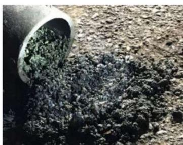
ガス管を閉塞した土砂
