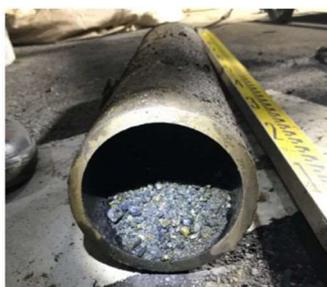
ガス管内に堆積した土砂
