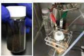
左図) PEMCO<sub>2</sub>還元用触媒 (大阪大学提供)
